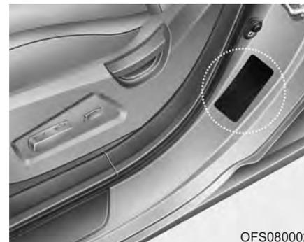
На табличке сертификации автомобиля (которая находится на средней стойки со стороны водителя или пассажира) имеется идентификационный номер автомобиля (VIN).
