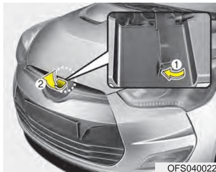
2. Подойдите к передней части автомобиля, приподнимите капот, потяните за рычаг его блокировки (1), находящийся в центральной части капота, и поднимите капот (2).
