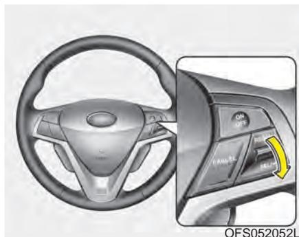
3. Нажмите выключатель SET- и отпустите его на нужной скорости. На приборной панели загорится контрольная лампа SET (Установка). Одновременно с этим отпустите педаль газа. Желаемая скорость будет поддерживаться автоматически.
