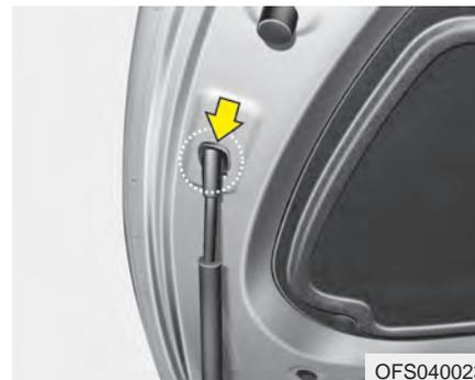
3. Выньте упор капота из места его крепления на капоте.
