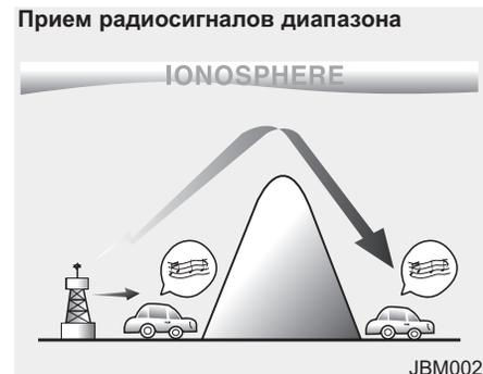
Сигналы AM-диапазона могут приниматься на большем удалении от радиостанции, чем сигналы FM-диапазона. Это возможно за счет более низкой частоты радиоволн AM-диапазона. Эти радиосигналы с большой длиной волны и низкой частотой распространяются не по прямой линии в атмосфере, а могут огибать земную поверхность. Кроме того, они огибают препятствующие их распространению объекты, что обеспечивает лучший прием сигнала.
