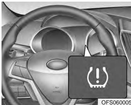
Позиционный сигнализатор низкого давления в шинах/Индикатор неисправности системы TPMS
