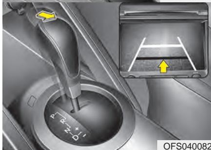
Система контроля мертвой зоны видимости перед автомобилем представляет собой вспомогательную систему, которая предназначена для вывода изображения мертвой зоны видимости перед автомобилем на экран аудиовизуального монитора.
