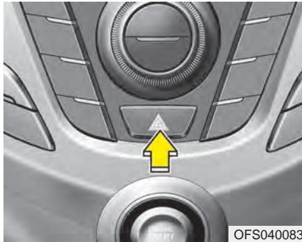
Для выключения аварийной сигнализации надо еще раз нажать на соответствующую кнопку.
