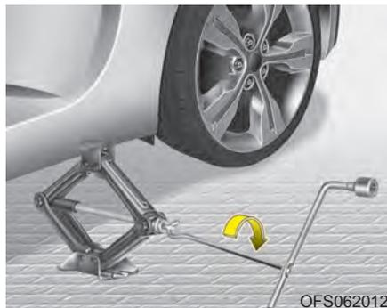
8. Вставив рукоятку домкрата и поворачивая ее по часовой стрелке, поднимайте автомобиль до тех пор, пока колесо не оторвется от земли. Это расстояние составляет примерно 3 mm (1,2 дюйма). Перед тем как откручивать колесные гайки, убедитесь в устойчивости автомобиля и в отсутствии возможностей его передвижения или соскальзывания.
