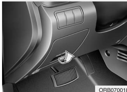
Панель предохранителей на приборной панели
