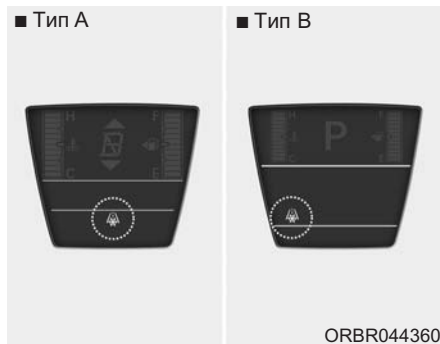
Сигнализатор обледенения дорожного покрытия (при наличии)
